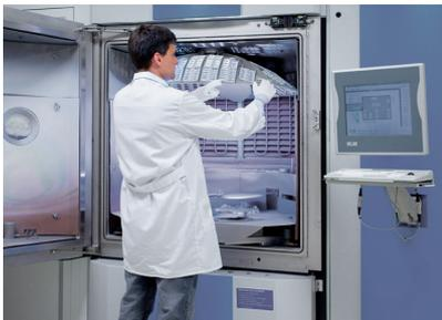
Bestückung der Hochvakuumbedampfungsanlage SYRUSpro
